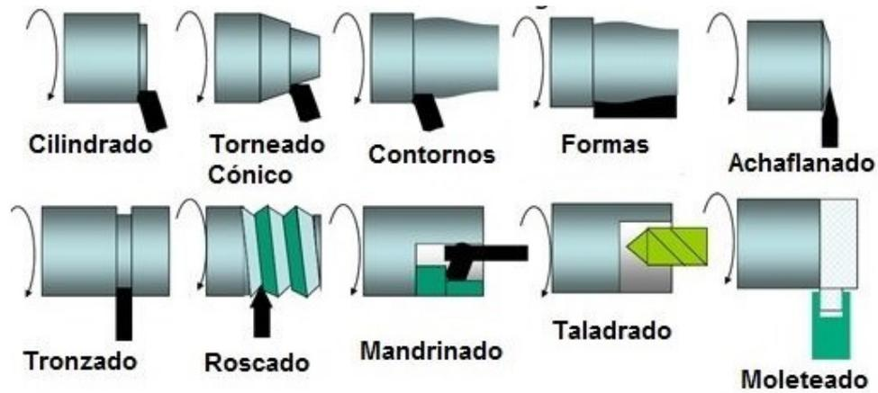
Figura 7. Procesos de mecanizado con torno
