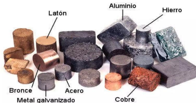
Figura 1. Ejemplos de metales ferrosos y no ferrosos
