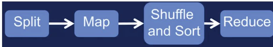
Figura N.º 1. Big Data Processing Pipeline.
