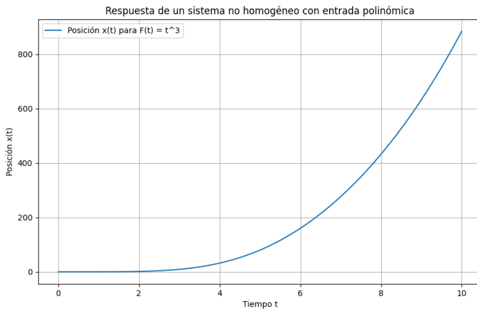
Gráfico 5: Solución particular de un sistema no homogéneo con entrada polinómica.
