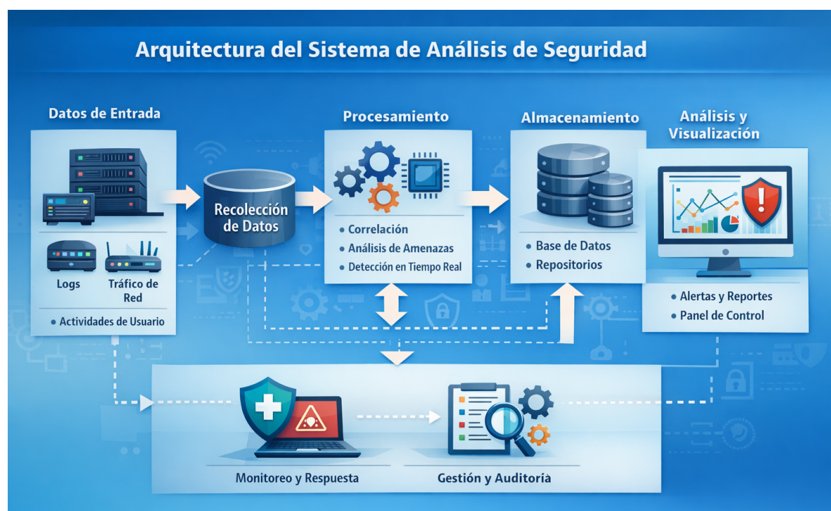
Figura 1. Arquitectura de un sistema de análisis de seguridad. Creación de autor Patricio Coba
